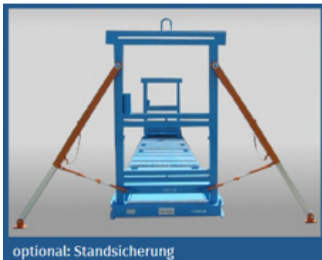
Standsicherung Innenlader sicherstellen.
