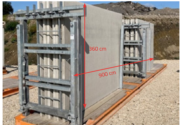
Bernecker Innenlader (im Bild sind die maximalen Elementabmessungen (3,6x9,0 m) für Innenladerpaletten dargestellt)
