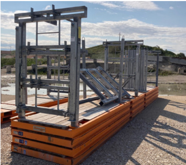
Bauseitige Vorbereitung für Innenlader für den Abtransport: Bis zu 4 Innenlader können übereinandergestellt werden.
