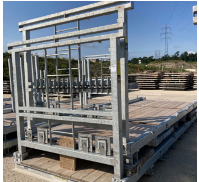
Bauseitige Vorbereitung für Absetzpaletten für den Abtransport: Bis zu 4 Absetzpaletten können übereinandergestellt werden.
