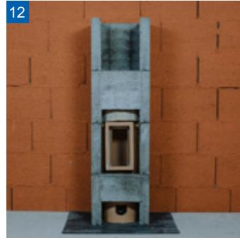
RAUCHROHRANSCHLUSS herstellen. Ist die erforderliche Anschlusshöhe erreicht, entsprechenden Mantelstein einbauen. Öffnung entlang der Einkerbung ausschneiden (Bild 4). Andere Anschlusshöhen werden durch das Versetzen von ganzen Mantelsteinen erreicht.
