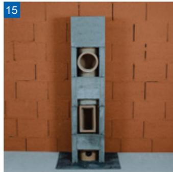
Zunächst zwei Mantelsteine setzen und je eine Isolierung und Schamotterrohr einbauen. Im Rhythmus, Mantelstein - Isolierung - Schamotterrohr, fortfahren.
