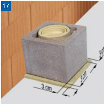
Abstände bei Decken- oder Dachdurchführungen mit nicht brennbarem Material ausfüllen. Abstände:
