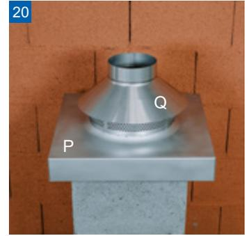
Mündungskonus\* auf Kamin Abdeckung setzen und mittels Klemmband befestigen. Bei Abdeckplatten anderer Art, zB Verblechung, ist darauf zu achten, dass der Hinterlüftungsringspalt von 4 cm frei bleibt.
